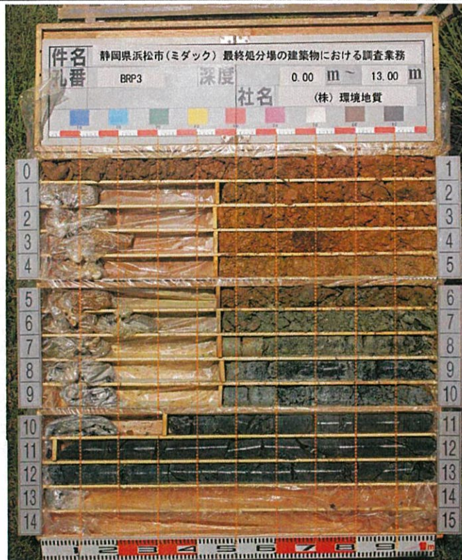
図 1.4 BRP-3 孔のボーリング柱状図及びコア写真
